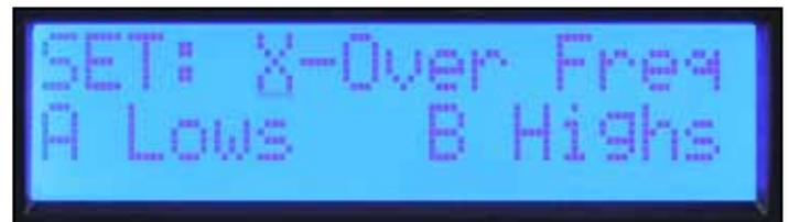
**Establezca: Pantalla X-Over Freq A Lows B Highs**
